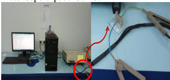
Gambar 4 Proses penentuan karakter dielektrik udara dengan LCR-Meter
