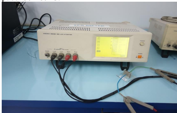
Gambar 3 Rangkaian sistem pengukuran karakteristik dielektrik minyak sereh wangi
