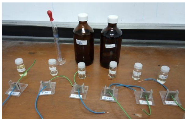
Gambar 2 Preparasi sampel minyak sereh wangi pada varian konsentrasi geraniol
